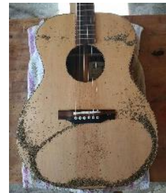
Le premier mode d'ordre supérieur T1,2 , généré par les "tone braces" présentes dans la zone inférieure de la table.
