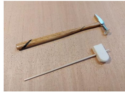
Marteau d'horloger, environ 25 grammes, et marteau avec un morceau de gomme Mars plastic Staedtler.
