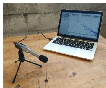
Setup minimale de mesure acoustique, microphone USB Umik-1 et logiciel freeware
