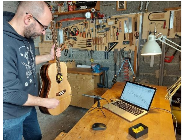
Voici comment nous effectuons des mesures de réponse en fréquence dans notre atelier.
