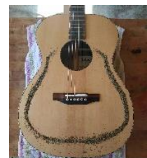
La résonance principale de la table d'harmonie, le monopole T(1,1)_2
