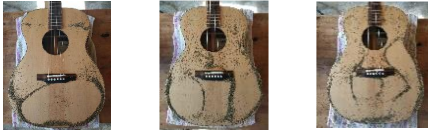
Modes de résonance d'ordre supérieur d'une guitare avec structure de barrage de type X Martin.
